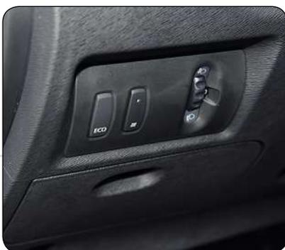
**Bild 5: Der Taster für den Eco-Drive-Modus ist etwas versteckt angebracht; trotzdem lohnt sich eine häufige Nutzung**
